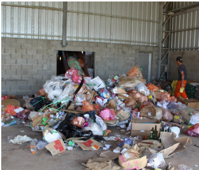
Playón de descarga e ingreso en cinta de clasificación de los Residuos Sólidos Secos recuperables proveniente de la recolección domiciliaria (imagen tomada en la Planta de Recuperación de la ciudad de El Trébol).
