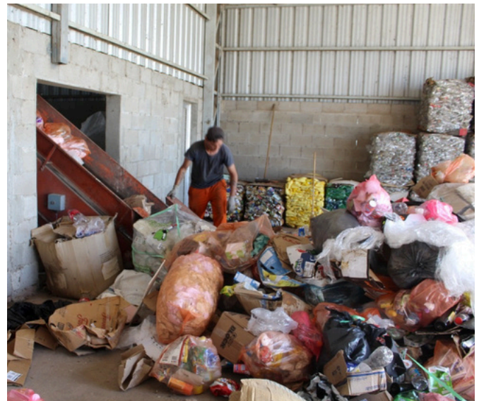
Playón de descarga e ingreso en cinta de clasificación de los Residuos Sólidos Secos recuperables proveniente de la recolección domiciliaria (imagen tomada en la Planta de Recuperación de la ciudad de El Trébol).
