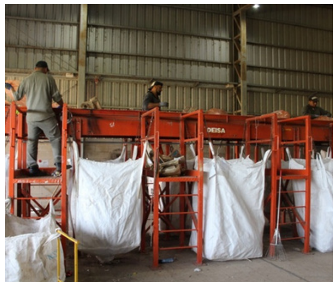
Trabajo de los operarios en cinta de clasificación de Residuos Sólidos Secos (imagen tomada en la Planta de Recuperación de la ciudad de El Trébol).
